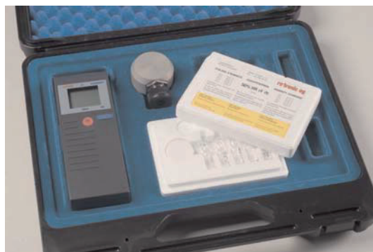
Fig. 110 Kit simples para calibração de termohigrómetro digital
