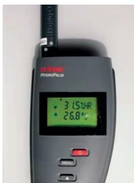
Fig. 108 Pequeno termohigrómetro de baixo custo. Alguns destes aparelhos possuem uma função de registo do valor máximo e mínimo (para a temperatura e a H.R.) alcançados durante um determinado período (à esquerda)
