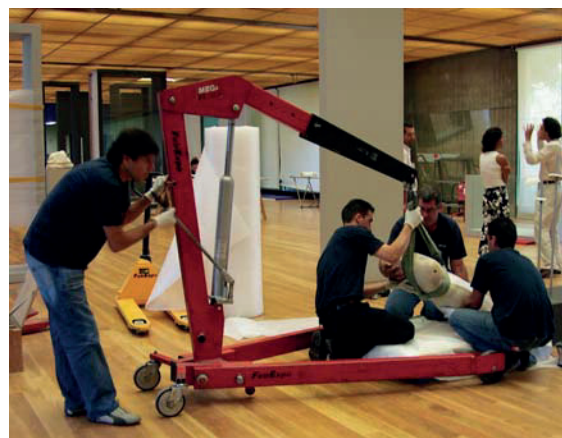
Fig. 94 Manuseamento de um objecto pesado com recurso a uma grua
