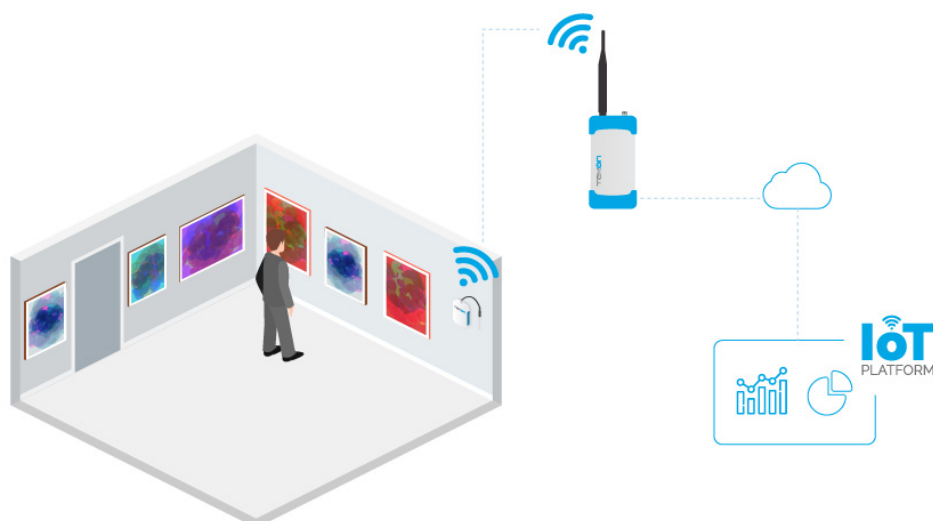
Figura 2 - Exemplo de aplicação DUOS HYGROTEMP + TEKON IoT PLATFORM
